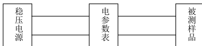
图 A3-1 测量线路图
